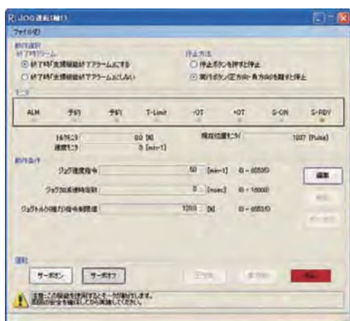
试运转功能 通过计算机输入速度指令，即可简单的使电机进行运转。
