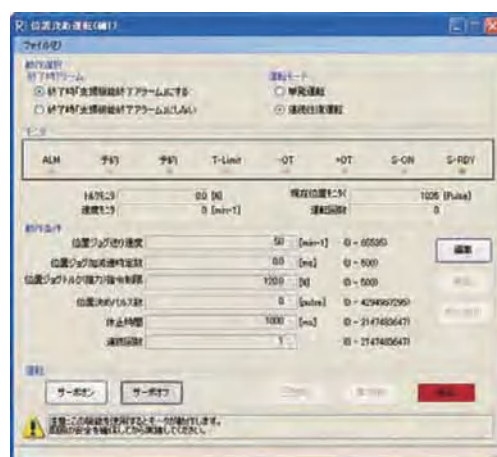
定位运转 通过计算机输入移动量和移动速度，即可简单的使电机进行运转。
